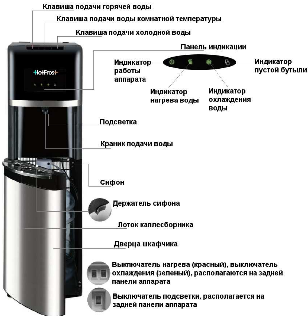
Рис.1 Схема аппарата 35A (S,N)
