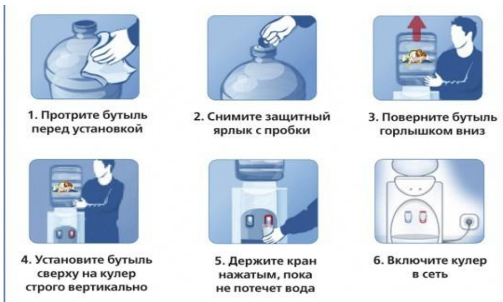
Рис. 3. Установка бутылки и подключение
