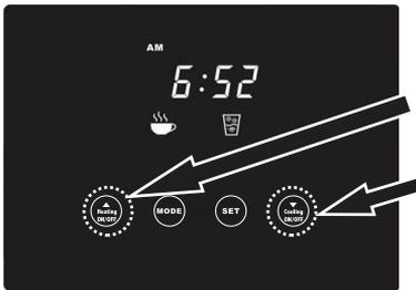
Нажмите кнопку “ВВЕРХ” и держите 3 секунды для включения или выключения нагревательной системы.
